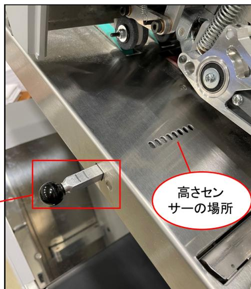
図 5-11 : 封筒の高さ調整
